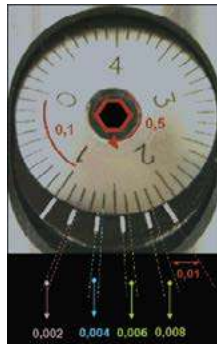
Градированный лимб 0.01 мм с круглой шкалой нониуса 0.002 мм
