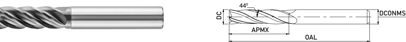
Утолщённый хвостовик для диаметров до 6 мм
