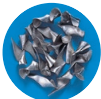
SUS304 EX-SUS-GDR \phi 8.5 切削速度 18m/min 送り量 0.2mm/rev
