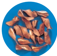
C1020(銅) EX-SUS-GDR \phi 8.5 切削速度 32m/min 送り量 0.24mm/rev
