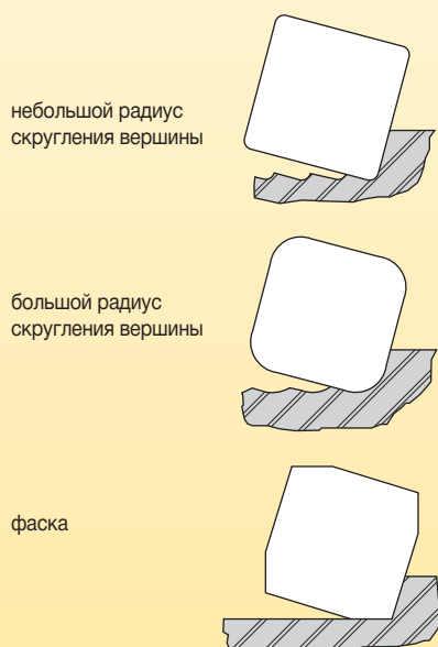
Рис. 1. Увеличение радиуса скругления вершины или ширины фаски обеспечивает повышенное качество обработанной поверхности.
