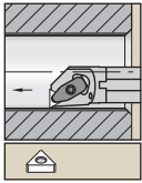
Стальная оправка с внутренним подводом СОЖ
