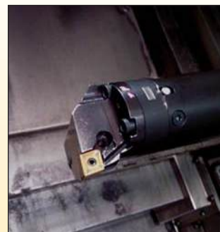
Рис. 3. Лыска на кольце расточной оправки
