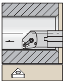
Стальная оправка с внутренним подводом СОЖ
