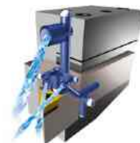
Высокоэффективное прямое охлаждение режущей кромки благодаря GARANT есо
