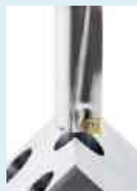
Засверливание на остром углу.
