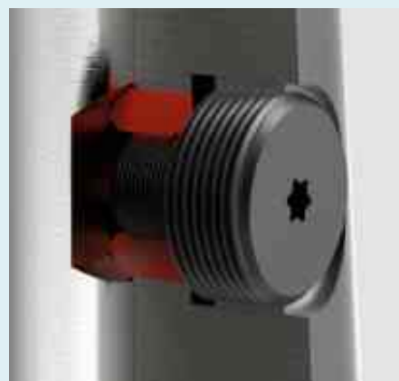
Ступенчатый затяжной винт. Разный шаг резьбы на разных участках винта. Необходимое усилие зажима требует меньшего момента затяжки.
