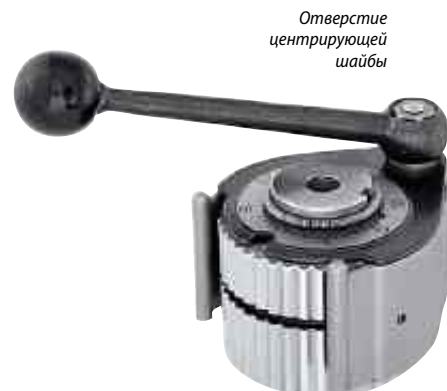
Отверстие центрирующей шайбы Высокоточные шлифованные зубья. Точность повторяемости закрепления 0,01 мм. 31 8000
