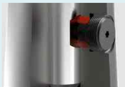
Прижимная деталь затяжного винта удерживает фрезу по всей площади лыски на хвостовике.
