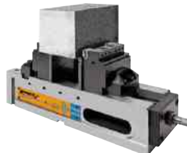
Зажимание необработанной заготовки простой конфигурации в клиновых вставках на высоких губках - удобно для 5-сторонней обработки.
